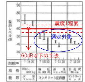
図29 解体工事による振動レベル例
