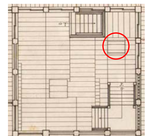
円内に蓋らしき物が描かれている。 「昭和実測図 名古屋城初層初層平面図」を加工
