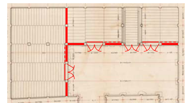
小天守地階の復元原案 「昭和実測図 名古屋城小天守地階平面図」を加工
