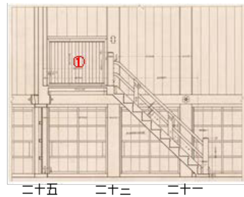
【図1】 寛文9年追加の二階～三階表階段格子窓 「昭和実測図 名古屋城天守二層表階段断面 詳細図(引戸詳細図)」を加工
