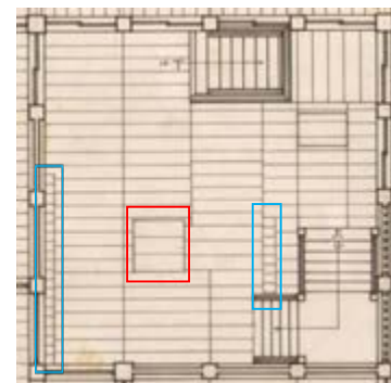
井桁の穴と排水溝を塞いだ跡がある。 「昭和実測図 名古屋城初層初層平面図」を加工
