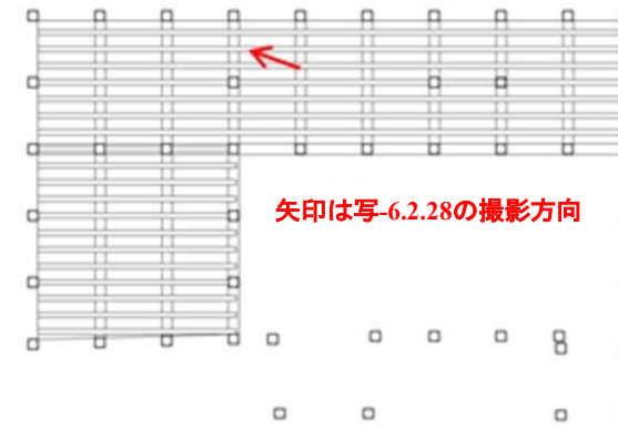
図-6.2.88 大正6年の写真から推定した大引・根太配置
