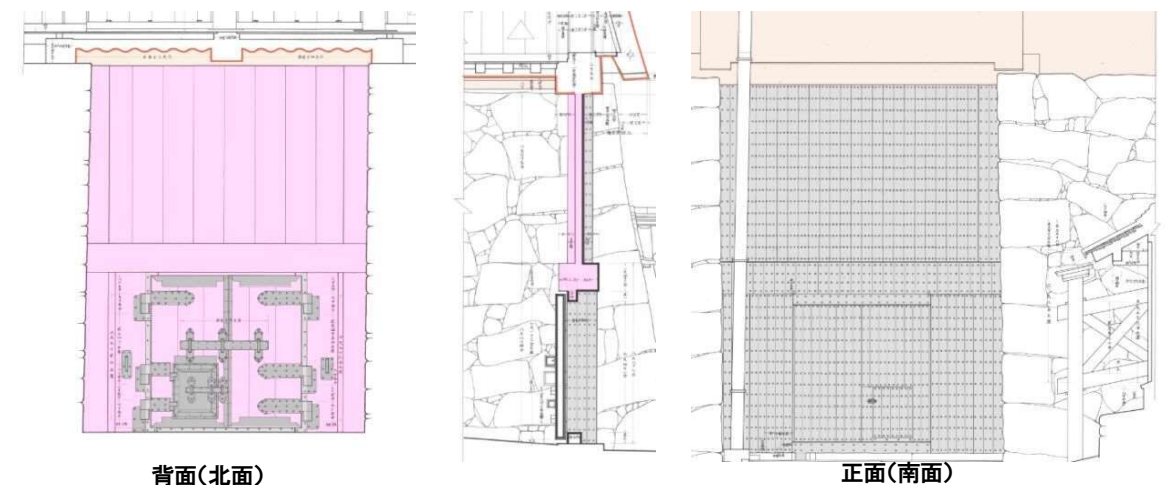
図-6.258 口御門廻りの仕上げ区分 :漆喰 :素木 :鉄板
