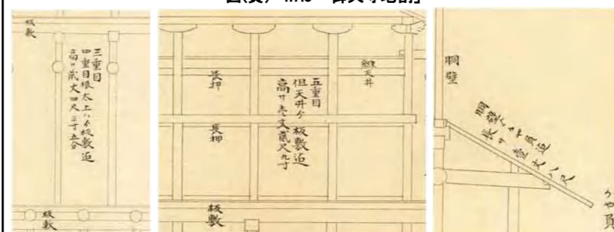
③拡大:3階高さ寸法 ④拡大:5階高さ寸法 ⑤拡大:外壁から茅負までの寸法
