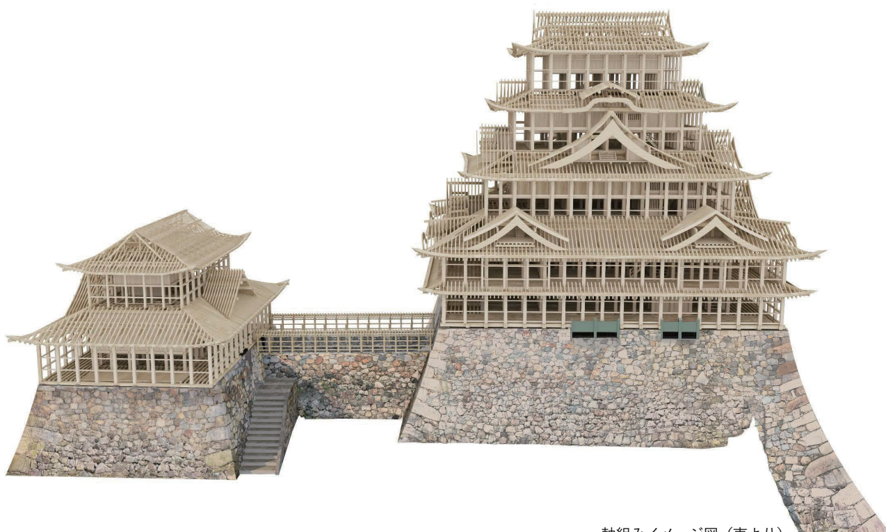
軸組みイメージ図（東より） 提供：名古屋城総合事務所 制作：竹中工務店
