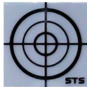
計測点(反射対標)例
