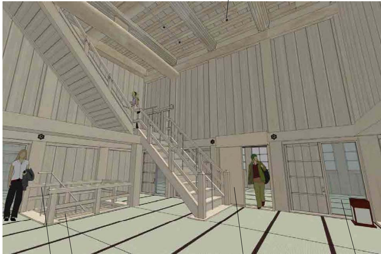
床開口部に遮煙用の水平引戸設置 長押下を史実通り壁または板戸とした場合
