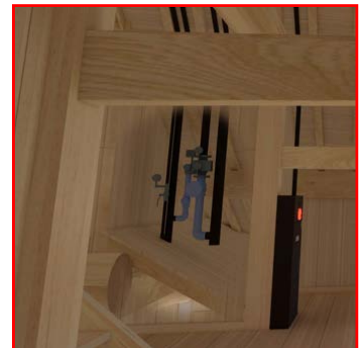
板壁裏暗部のアラーム弁を示しています↑ (ケンドン式とした板壁を外す対応を計画しています)
