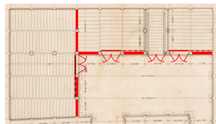
小天守地階の復元原案 「昭和実測図 名古屋城小天守地階平面図」を加工
