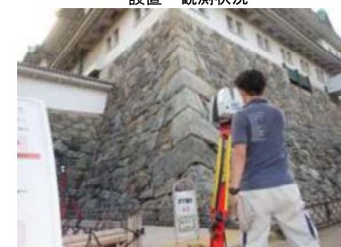
写真 2.4 地上レーザ計測
