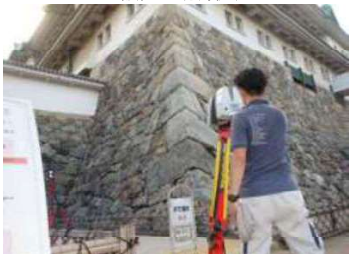
写真 2.4 地上レーザー計測
