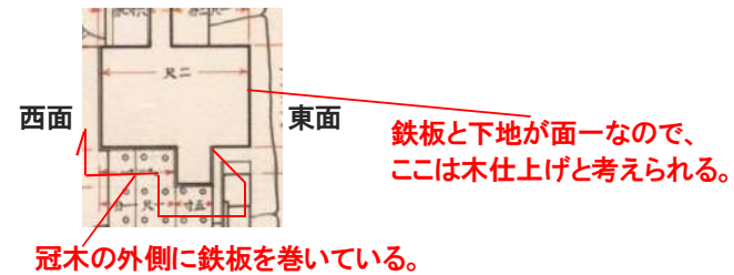
図-6.252 地階奥御門の冠木断面図 昭和実測図「地階奥御門正面及断面詳細図」(部分)
