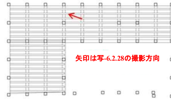
図-6.2.75 大正6年の写真から推定した大引・根太配置
