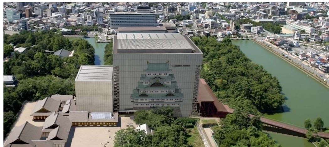
図-7.1.14 素屋根置完了イメージパース
