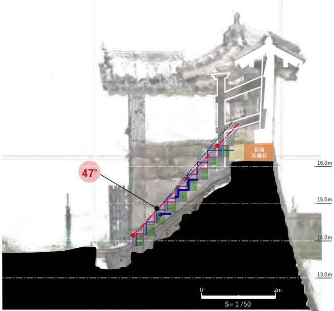
図 22 断面 C 断面図 + 立面陰影図（見通し）
