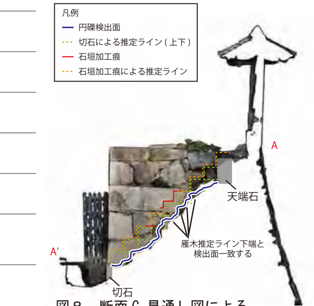
図 8 断面 C 見通し図による 雁木の断面位置の検討
