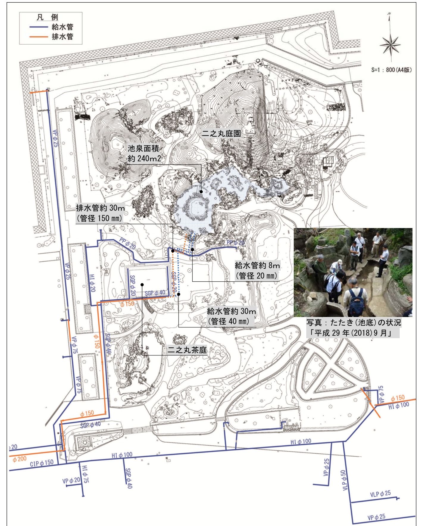
図: 名勝名古屋城二之丸庭園 現況の給水・排水平面図 (S=1:800)
