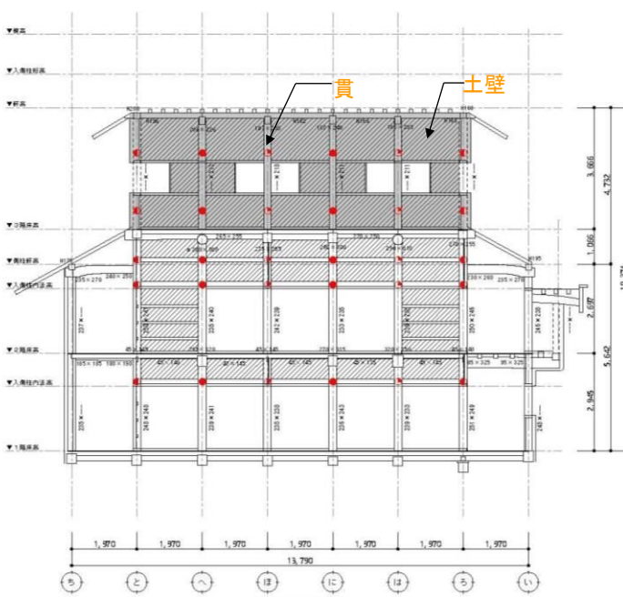
図 12 耐力要素の例（六通り軸組図） （灰色が土壁，●：貫・ほぞ） ●通し貫 ○通し貫（略鎌継） ○ほぞ・大入れ
