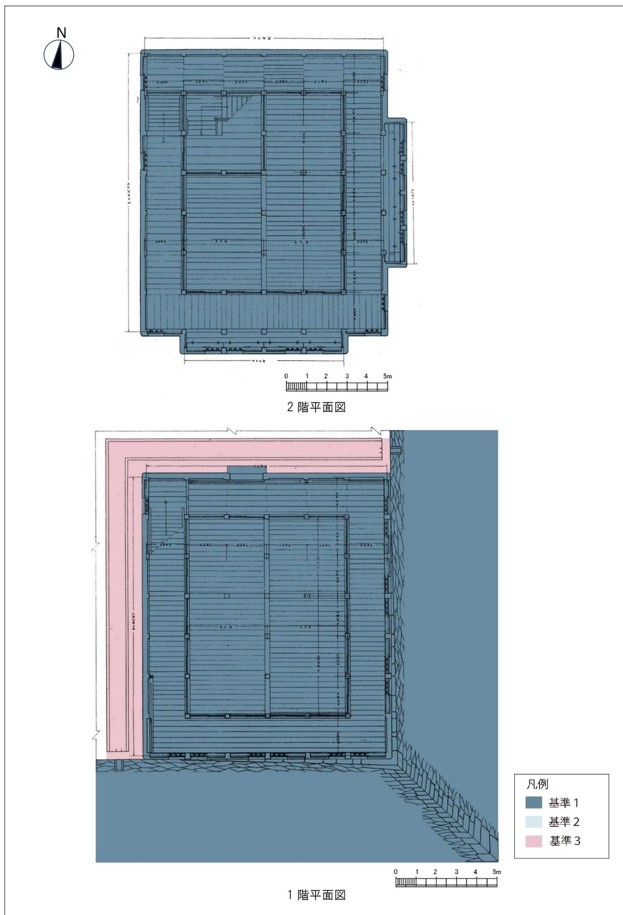
図 2-5 部分及び部位の保護方針【東南隅檜 (A02) 1・2 階平面図】
